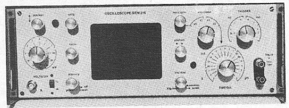
Afb. 1 Oscilloscoop BEM 016, in enkelvoudige uitvoering.
